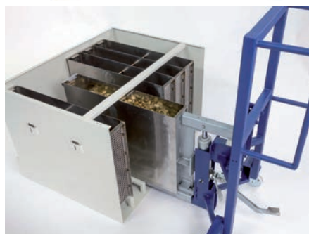
Fasi di inserimento o prelievo dei contenitori dalla selezionatrice automatica.
