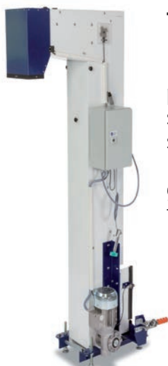
L'elevatore NGZ 208, integrabile nel sistema, accoglie due contenitori per volta, svuotati alternativamente per un'alimentazione continua del trasferimento.
